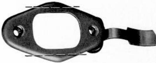
2 - Schaltstangenlager einsetzen und mit zwei Sechskantschrauben am Rahmen befestigen.
