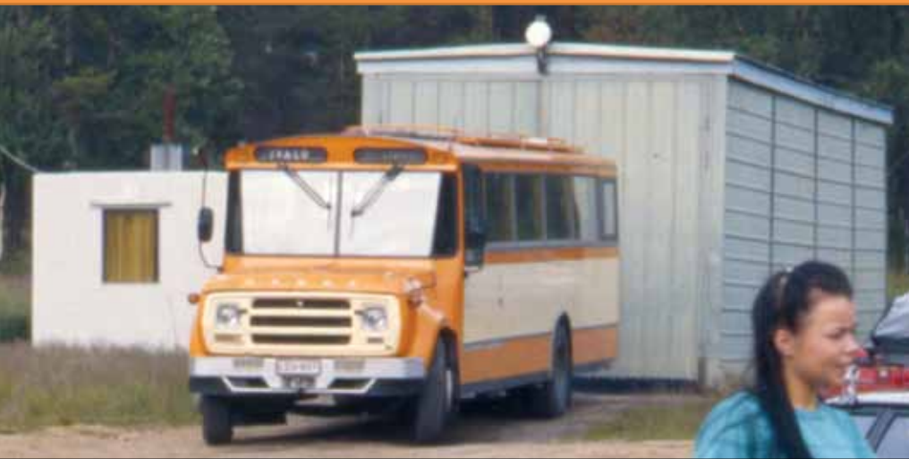
Lapin ankarat olot herättivät ajatuksen kovaan käyttöön tehdyn nokkabussin kehittämisestä. Tällaisia autoja tehtiin Dodge-alustoista sarja Tampereen postiautovarikolla 1982-83. Autoissa oli muutostöiden jälkeen miltei enemmän Sisun ja Valmetin osia kuin Dodgea. Kuvassa nokkabussi on Ivalossa postibussitalin edessä. Kuva: Martti Hellsten
