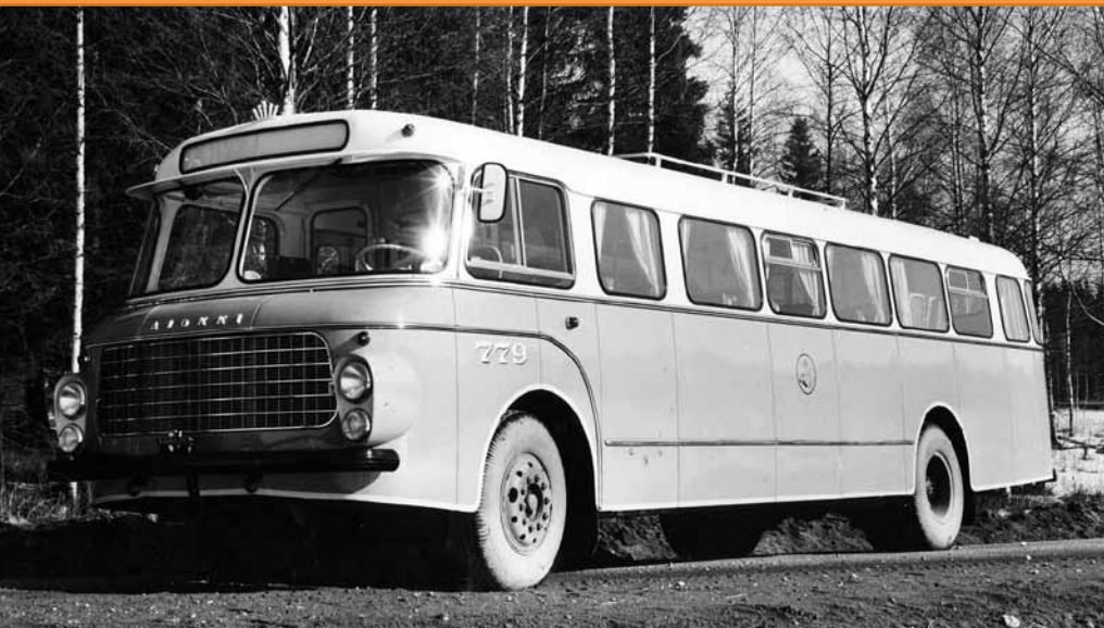
Vuonna 1959 Ajokin korimalli uudistui. Koriin oli lainattu muotoja samanikäisestä Ford Fairlane –henkilöautosta ja moneen koriin asennettiin taakse tämän automallin takavalot. Näiden valojen FoMoCo-tekstistä (Ford Motor Company) tulee tämän korimallin liikanimi ”Fomoco-Ajokki”. Postin autoihin ei yleensä näitä kalliimpia ja hienompia takavalvoja asennettu. Kuvassa on yksi ensimmäisistä koreista, minkä tunnistaa varsinaista valmistussarjaa pyöreämmistä ajovaloulokkeista. Kuva: Ajokki
